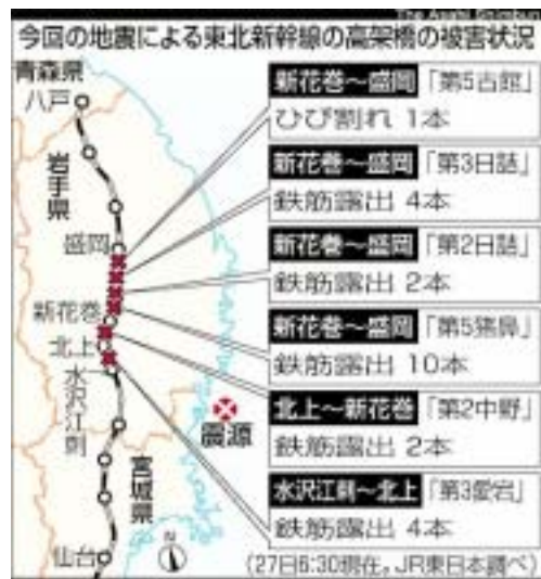
図 3.1.1 東北新幹線高架橋被害状況 3.1.1)
